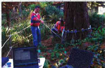
Agents de la cellule Expertise Arbres réalisant un tomographe.
